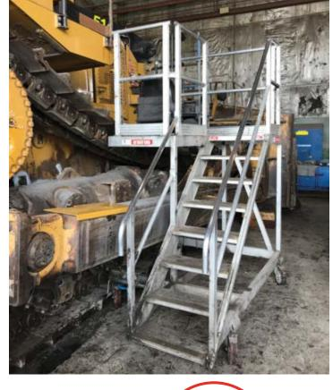
**HEAVY DUTY BOX SECTION ALUMINIUM FRAME**
